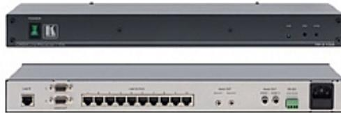
El **TP-310A** es un receptor de par trenzado de altas prestaciones y distribuidor amplificador para señales gráficas de video por ordenador, audio y RS-232. La unidad toma una entrada de par trenzado y entrega 10 salidas de par trenzado más 2 salidas gráficas de video por ordenador, dos audio estéreo, dos audio S/PDIF y dos RS-232 para monitorización local
