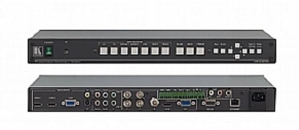
El VP-437N es un escalador/selector de 7 entradas para señales de compuesto, s-Video (Y/C), componente, gráficas de video por ordenador y HDMI con audio estéreo desbalanceado o S/PDIF. Escala la señal de video seleccionada a una resolución de salida gráfica de ordenador o HDTV, embebiendo el audio en una señal de salida HDMI.
